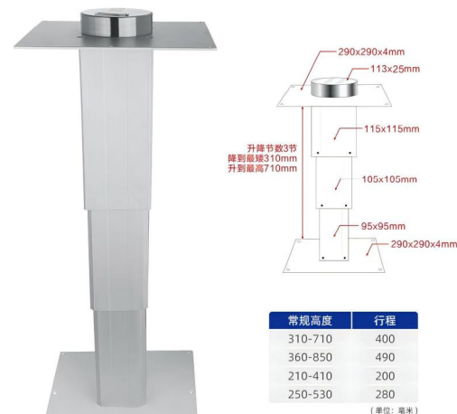
SDTTM-02 手动式榻榻米升降机 (中铝) Manual tatami lift (medium aluminum)
